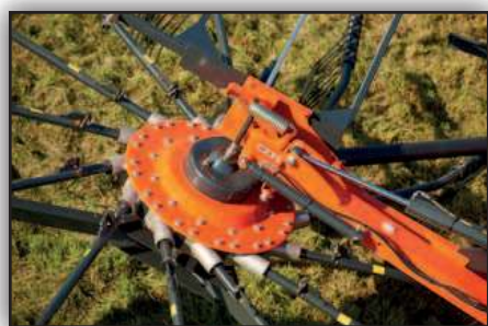
Hydraulische verstelling van werkbreedte RA2584: 7,60-8,40 m werkbreedte. RA2590: 8,00-9,00 m werkbreedte.
