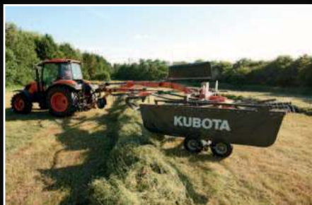
Dankzij een hefhoogte van ruim 50 cm kan over een zwad worden gereden.
