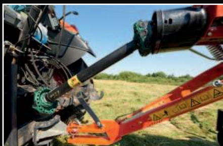
Beide modellen zijn uitgerust met een dubbele groothoek aftakas – om een verhoogde wendbaarheid te garanderen.
