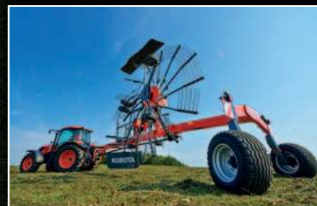
Gedwongen wielbesturing voor een betere wendbaarheid in combinatie met grote banden voor minder bodemdruk.
