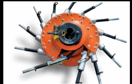
Onderhoudsvrije ProLine rotor – volledig gesloten en permanent gesmeerde rotor.
