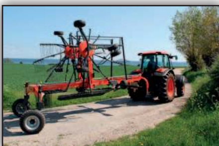
De RA2076 is voorzien van afneembare tandarmen, zodat de maximale hoogte 3,45 m beslaat.
