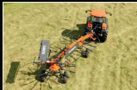
SideShift aan de linkzijde - de trekker rijdt niet over het gemaaid gras.
