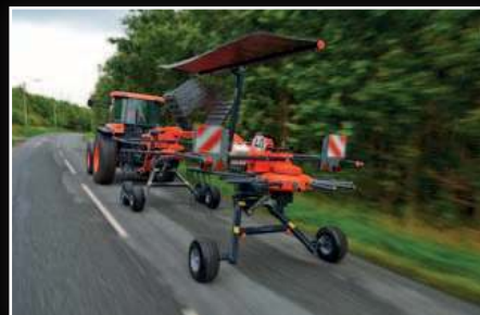
Getrokken assen voor een soepele werking en vermindering van benodigd vermogen.
