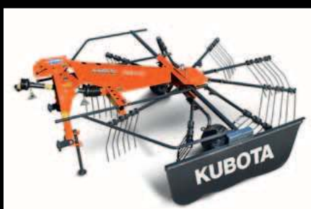
RA1032 – compact instapmodel 3,20 m hark met een gewicht van slechts 320 kg.
