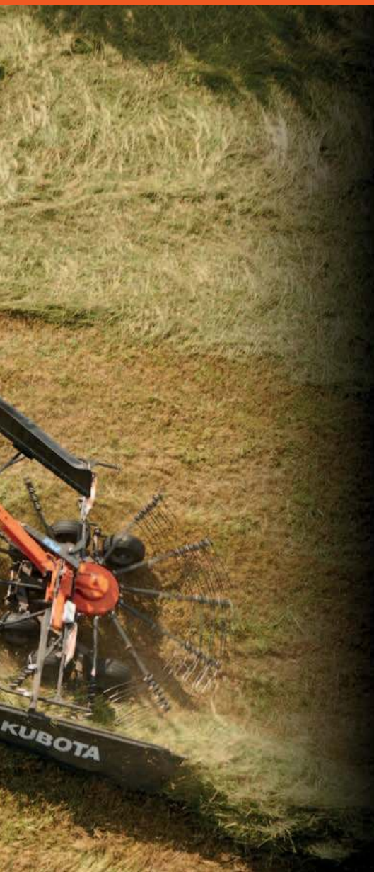
Dankzij een hefhoogte van ruim 50 cm kan over een zwad worden gereden.
