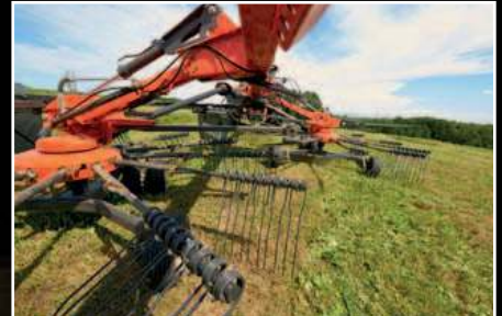
Royale overlap tussen de rotoren zorgen voor net harkwerk.
