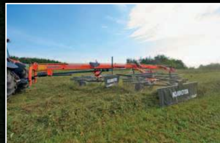
Het zwaartepunt van het achterframe ligt laag, wat resulteert in een betere stabiliteit.
